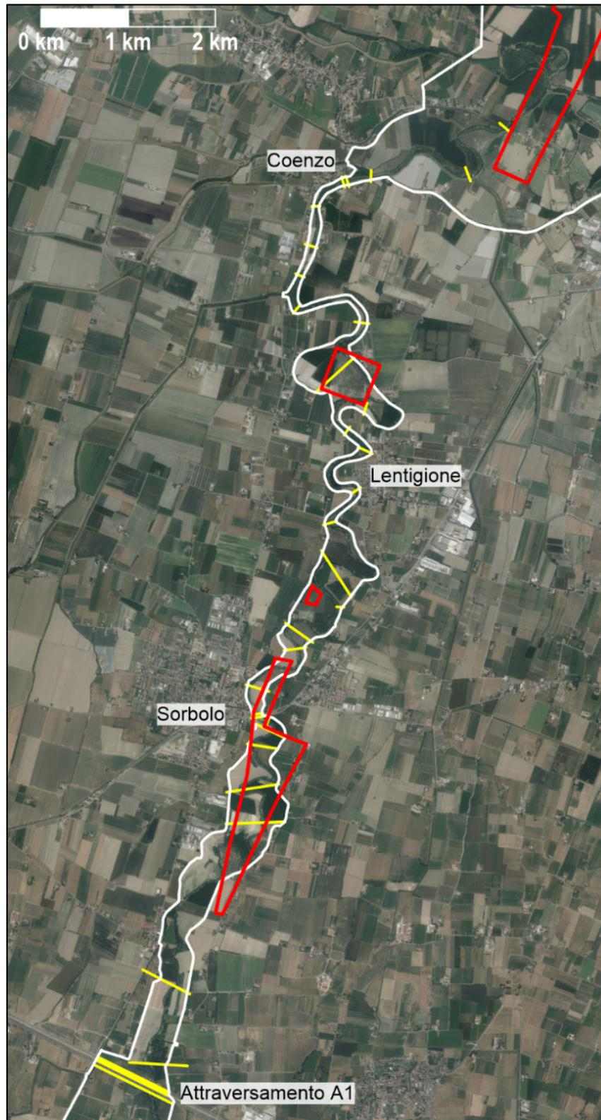
**Figura 1-23.** Copertura del DTM MATTM 2008 nel tratto a valle dell'A1: sono evidenziate in bianco le arginature e in rosso le zone non coperte dal rilievo; in giallo sono riportate le sezioni rilevate a terra nel 2011 e nel 2018.
