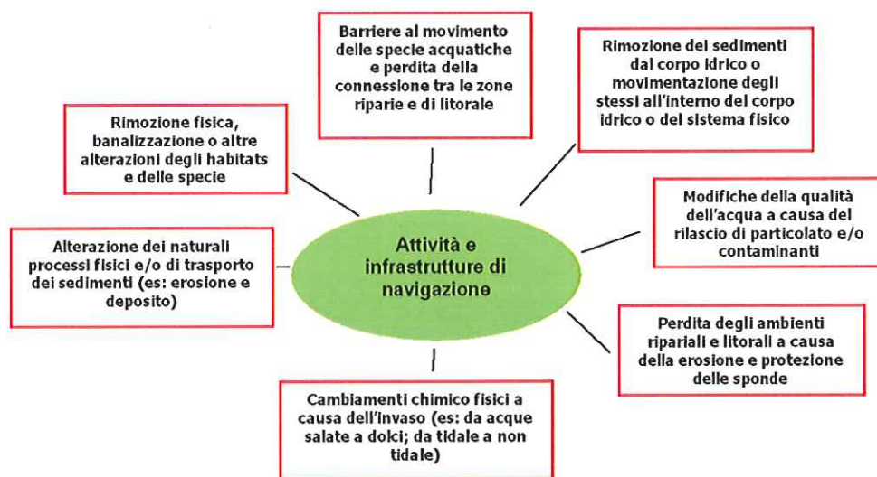
Figura 2 - Possibili alterazioni associate alla navigazione fluviale (da EU CIS 2006)
