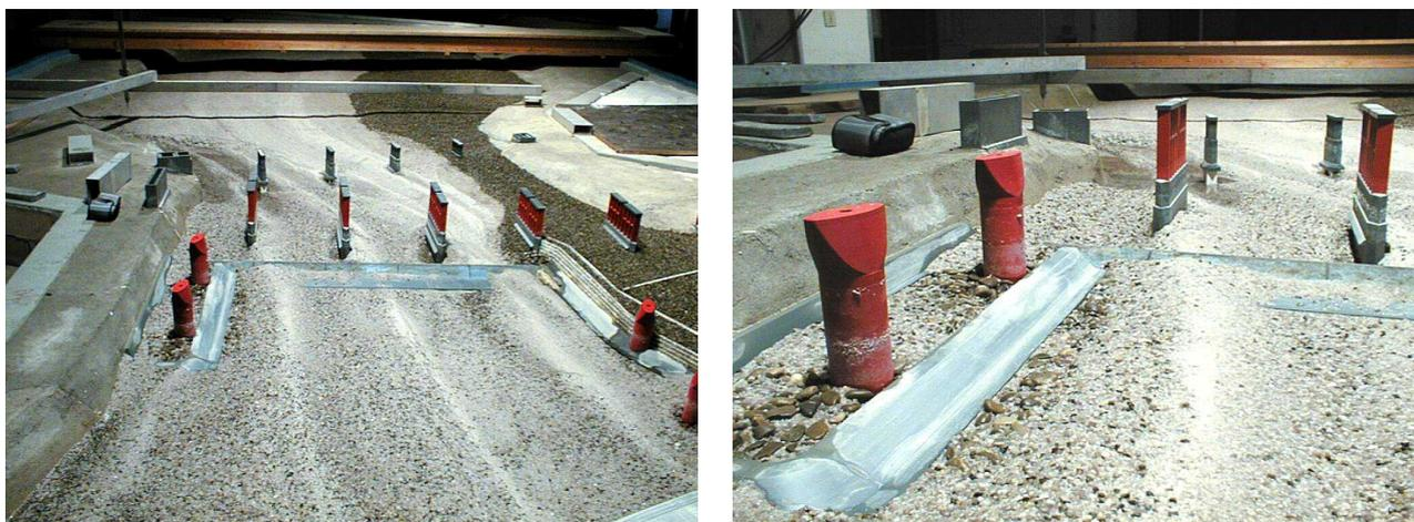
Figura 10 - Modello fisico a fondo mobile del ponte sul Fiume Reno della Variate di valico dell'autostrada A1 Bologna-Firenze. Laboratorio di Ingegneria Idraulica dell'Università di Bologna. Situazione al termine di una prova relativa alla portata millenaria. Vista di insieme da valle (sx) e particolare di una pila (dx, notare l'asportazione di alcuni massi di protezione).
