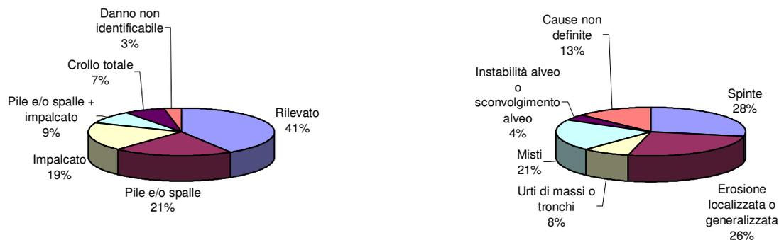
Figura 1 – Elementi strutturali dei manufatti di attraversamento danneggiati a seguito di eventi alluvionali (a sx) e cause di danno primario subito dai ponti (a dx). Dati desunti da Ballio et al. (1998).
