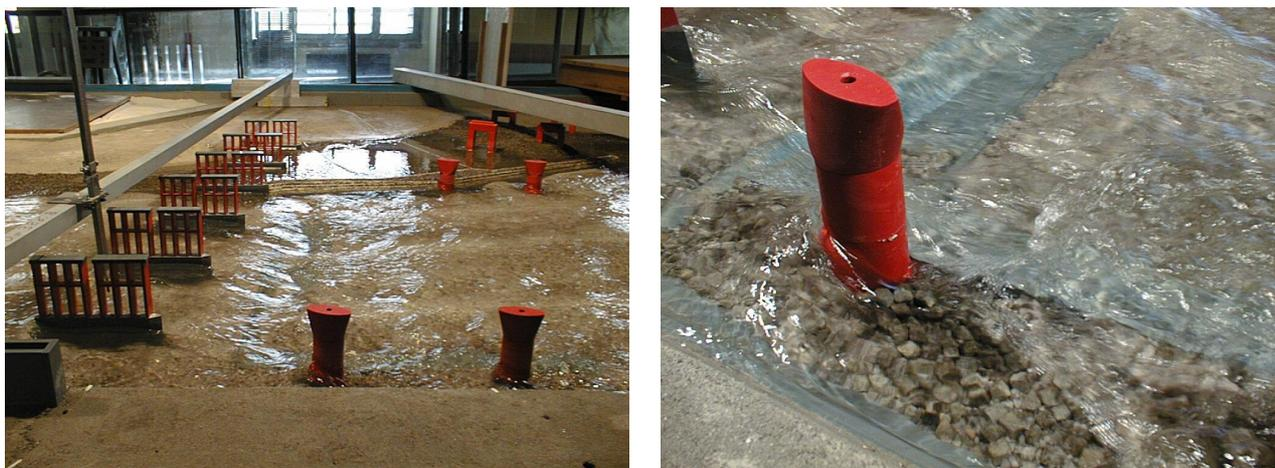
Figura 9 - Modello fisico a fondo mobile del ponte sul Fiume Reno della Variate di valico dell'autostrada A1 Bologna- Firenze. Laboratorio di Ingegneria Idraulica dell'Università di Bologna. Prove relative alla portata millenaria. Vista laterale di insieme (a sx) e particolare di una pila (a dx).
