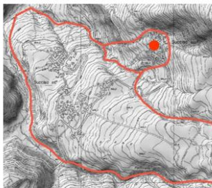
Figura 19: L'inclinometro I-59 ebbe una vita operativa dal 2011 al 2014 e fu poi sostituito dall'Inclinometro ("chiesa"), tuttora operativo. Come si vede, la velocità di spostamento media nel periodo è passata da 36 a 11 mm/anno sulla superficie di rottura posta a -38 metri di profondità.
