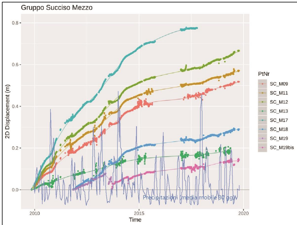
Fig. 27: Succiso di mezzo. Modulo (valore assoluto) degli spostamenti (proiezioni dei vettori sul piano orizzontale) delle 8 mire ottiche rispetto all'origine (fonte: UNIMORE). I valori medi di spostamento calano da circa 12 a 3 cm/anno. Il ginocchio che separa i due tratti delle curve si trova ancora intorno all'anno 2014.
