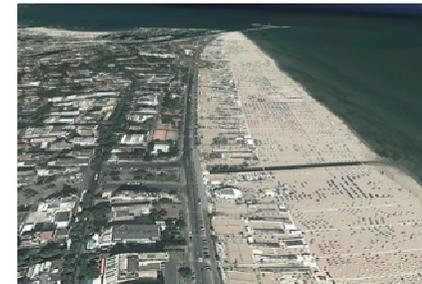
Tale assetto comporta, in corrispondenza di **eventi piovosi intensi**, condizioni di **sovraccarico sul sistema fognario**, non in grado di collectare e trattare tutte le portate generate dai deflussi, con conseguente **apertura degli scarichi a mare** nelle sezioni terminali delle fosse.
