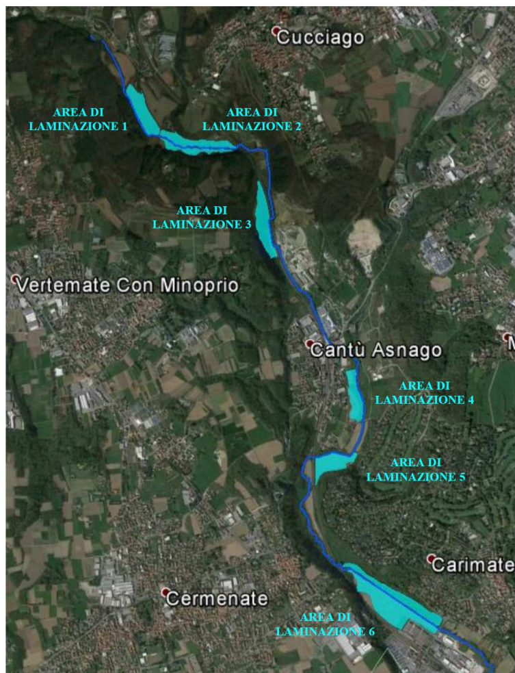
Figura 16 - Invasi di laminazione in aree golenali nei comuni di Vertemate con Minoprio, Cantù e Carimate, secondo quanto previsto nel progetto preliminare (aprile 2015)
