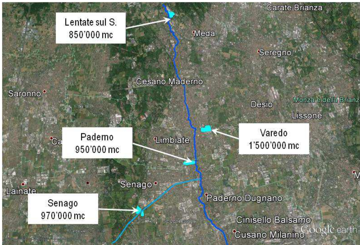
Figura 15 - Invasi di laminazione in scavo da Lentate sul Seveso al CSNO (come da studio AIPo-2011)
