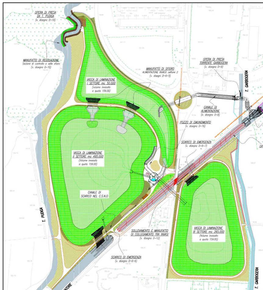
Figura 19 – planimetria di progetto dell'invaso di laminazione in Comune di Senago
