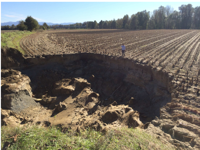
Figura 10. Voragine prodottasi a monte della rotta arginale . Il repentino cedimento del rilevato e l'elevato grado di saturazione dei terreni a monte hanno probabilmente favorito una riduzione significativa della resistenza al taglio dei sedimenti e la loro conseguente asportazione.
