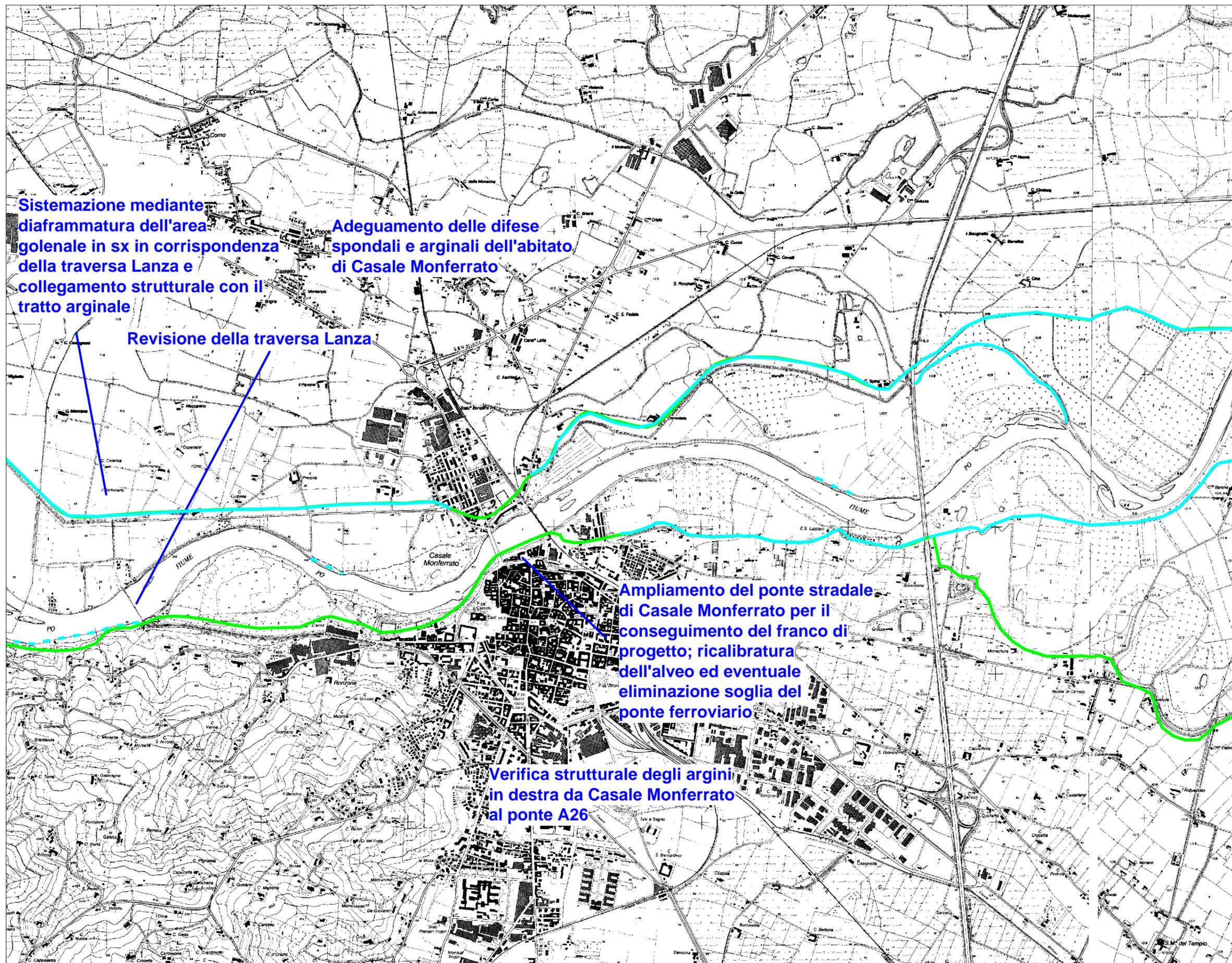
Sistemazione mediante diaframmatura dell'area golenale in sx in corrispondenza della traversa Lanza e collegamento strutturale con il tratto arginale
